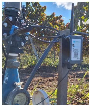
Existen dispositivos que permiten observar la humedad de suelo en tiempo real y ajustar las programaciones de riegos. Si inicialmente relacionamos el estado hídrico de la vid o el olivo con el contenido de humedad en el suelo podemos:
